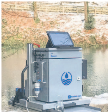
ColiMinder: cet appareil de mesure et d'analyse de la qualité microbiologique de l'eau permet de suivre automatiquement l'évolution et le niveau de contamination dans une rivière en temps réel.
