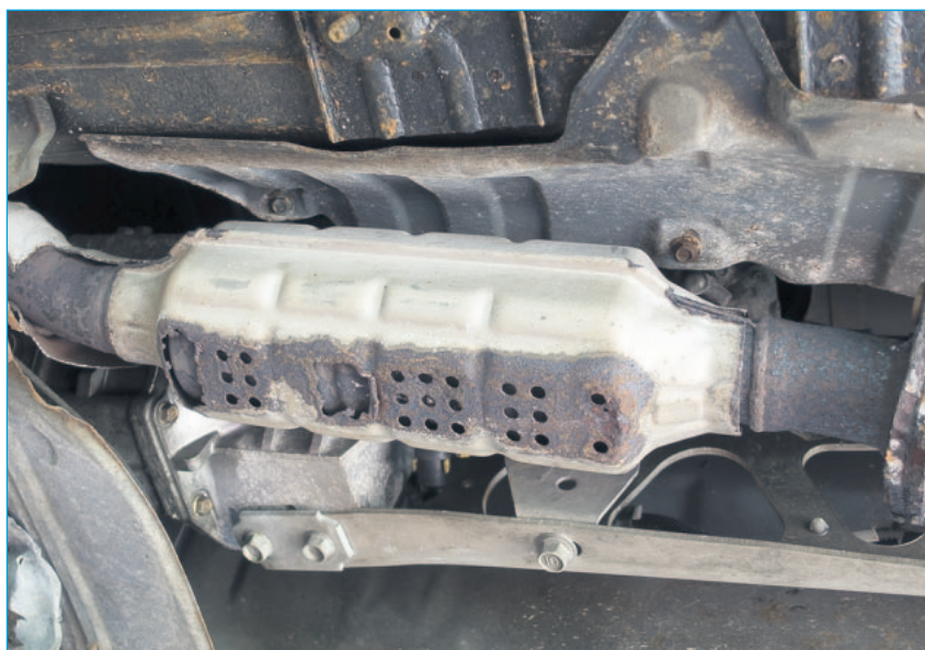
Le catalyseur est placé sur la ligne d'échappement afin de réduire la nocivité des émissions de gaz et de particules
