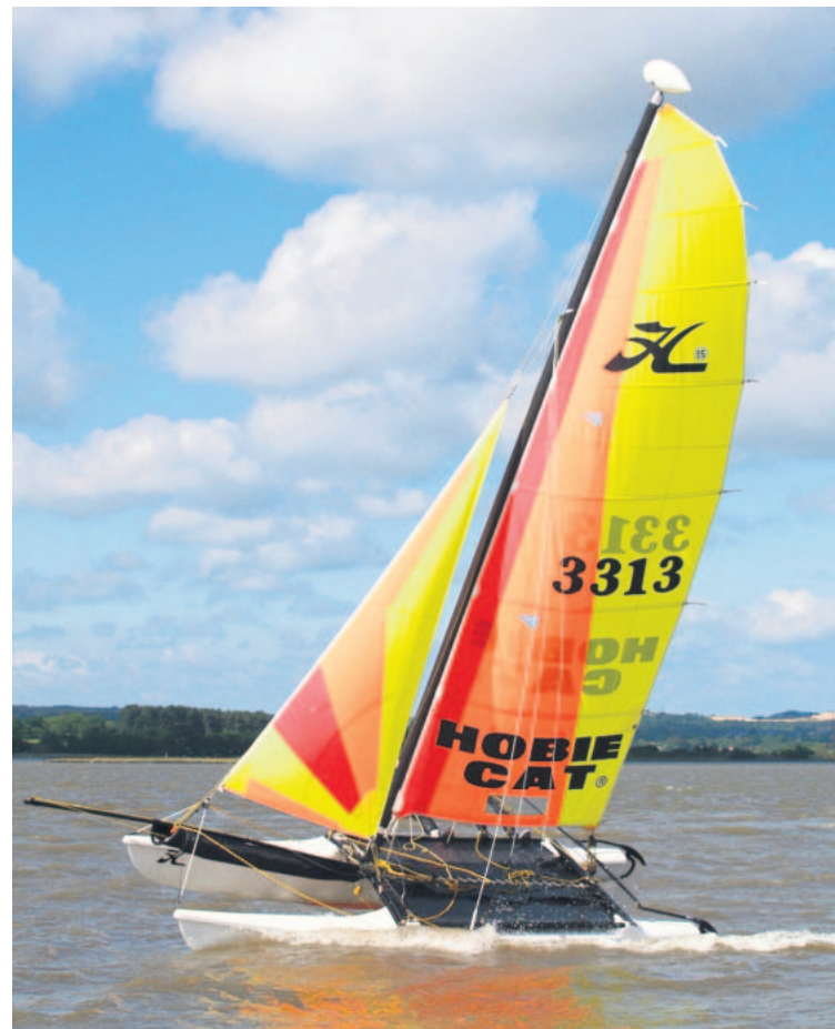
Un Hobie Cat c'est une embarcation particulière. Un seul mat, deux voiles, deux coques et un trampoline. Ce catamaran léger avec sa forme unique fend les flots à des vitesses inconnues des autres voiliers de plaisance. - photo: Diane Brault
