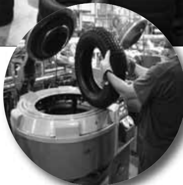
Le pneu écologique prend forme dans un moule issu d'une technologie italienne
